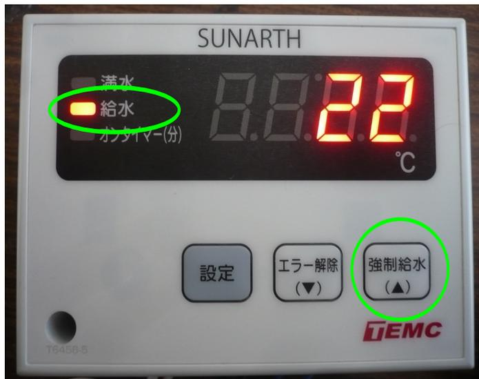
「満水」表示が点灯しましたら、「給水」ランプが消灯し、給水が終了します。
